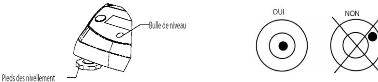
Figure 2-1. Mise à niveau de la balance.
